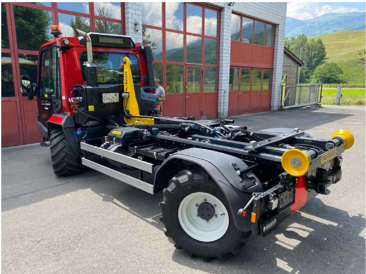
Das neue Fahrzeug mit Hakengerät und Kippmulde
