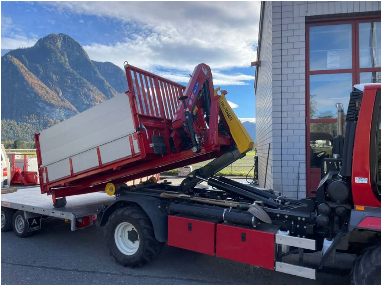
Das neue Fahrzeug mit Hakengerät und Kippmulde
