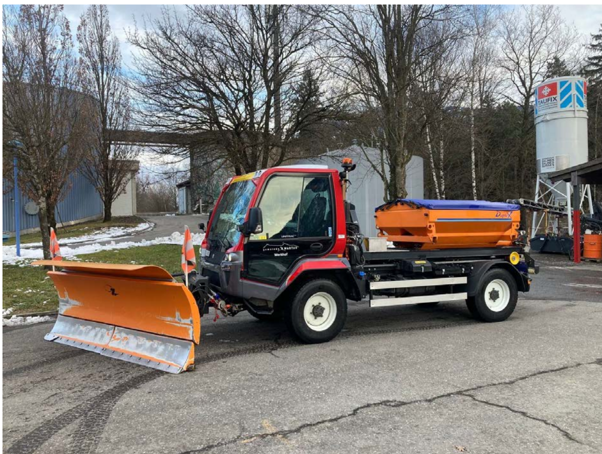
Das neue Fahrzeug mit Pflug und Salzstreuer aufgebaut auf Hakengerät
