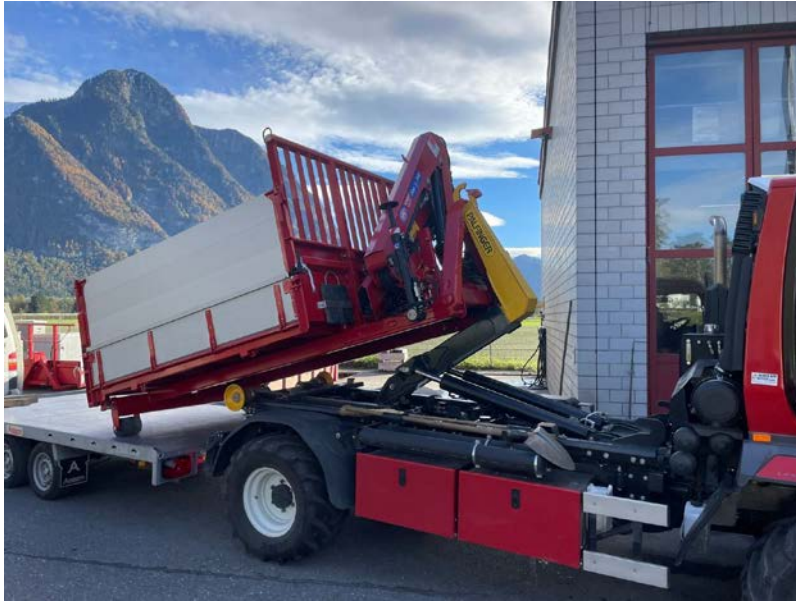
Das neue Fahrzeug mit Hakengerät und Kippmulde
