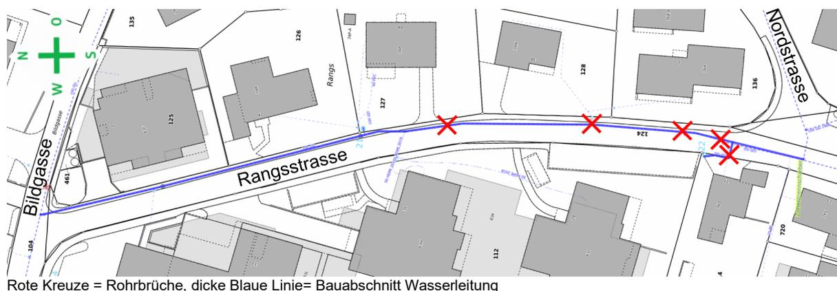
Rote Kreuze = Rohrbrüche, dicke Blaue Linie= Bauabschnitt Wasserleitung
